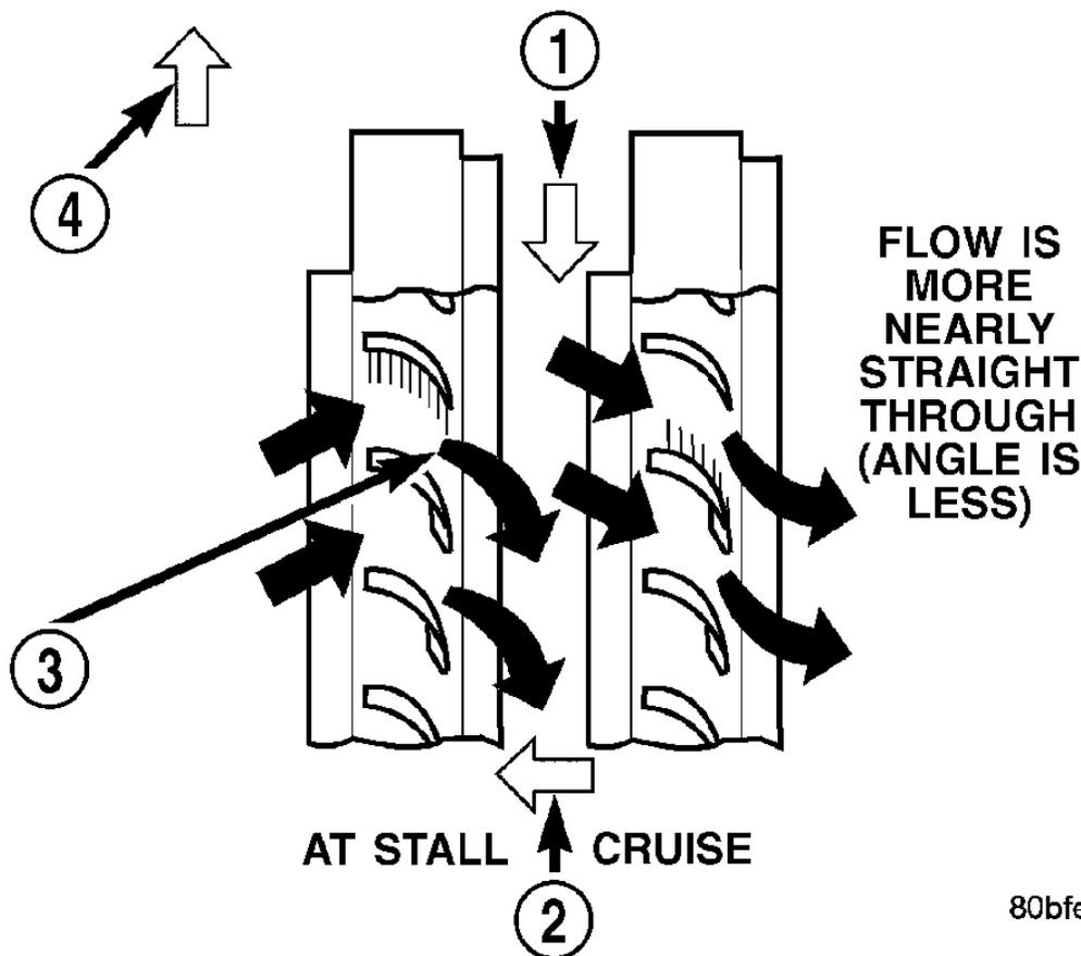
**Fig. 274: Stator Operation**
